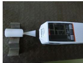
図4 加工面の表面粗さ測定
