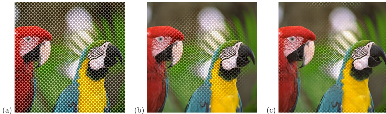
図 7: パターンが徐々に変化する場合のパターン分離結果. (a) 入力画像, (b) 画像全体を用いての分離結果, (c) ブロックごとに処理を行った結果
