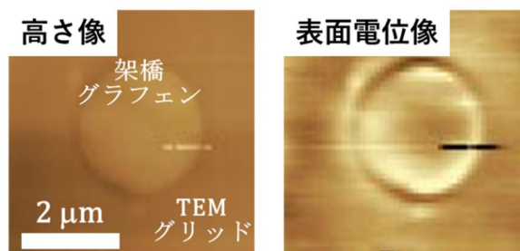
図3 架橋した単層グラフェン上の KPFM 計測結果
