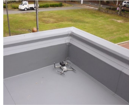
写真1 本研究に用いた無線加速度センサを積載したドローン
