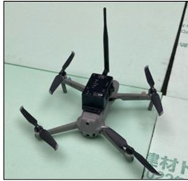
写真1 本研究に用いた無線加速度センサを積載したドローン
