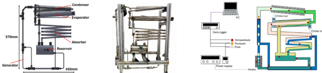
(a) 無電力・拡散型吸収式冷凍機の外観
