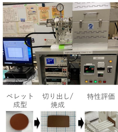
図1 熱電3物性評価装置(上)と試料および電極部(下)
