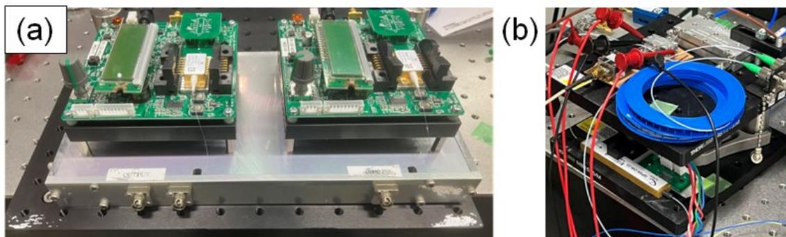
Fig. 3: (a) 自作 EDFA、(b) シングルサイド変調器関連備品を小型に実装した物。
