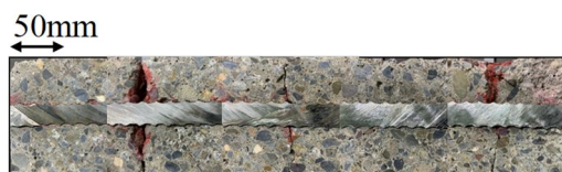
(a)供試体切断面のインク含浸状況例
