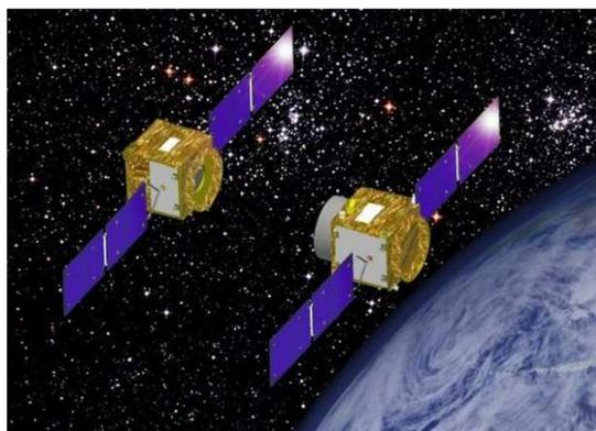
その概念図を上図に示す。FF の重要性は工学的には良く認識されているが、実現した例は少なく、まして理学への応用はない。低軌道地球周回衛星で FF を実行する場合、重力傾斜によりポインティングが困難であるため、大型望遠鏡への応用は難しい。今回の我々のアイデアは、ポインティングをせず、望遠鏡による広天走査という新発想に基づき、FF としては姿勢制御用燃料をほとんど使わない形態である。このアイデアは世界的にはまだ誰も提案していないもので、我々の独創性は高い。
