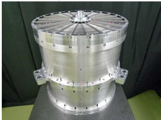
これらのスーパーミラーに関する技術はこれまで名古屋大学において独自開発されてきたもので、合計 4 回の気球搭載観測実験を通じて、衛星搭載品開発レベルに達している。この技術はひとみ衛星搭載の硬 X 線望遠鏡(HXT)と共通であり、確かな技術基盤を持つ。FFAST での要求性能は、有効面積が 30keV において 150cm<sup>2</sup>、結像性能が 2 分角(Half Power Diameter; HPD)である。また、新規開発要素もなく、開発期間の短縮、製作コストの低減という点からも、望遠鏡部分についてはこの開発形態が最適であると判断している。
