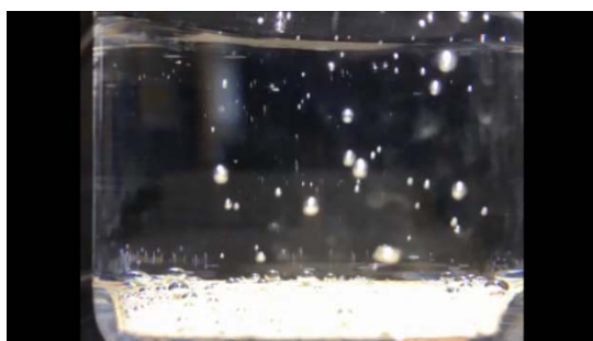
図5 光触媒シートを用いた水分解反応
