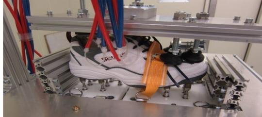
図4 空気圧を用いた着靴模擬歩行装置開発
