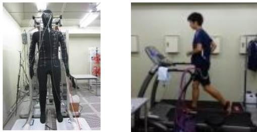
図3 歩行サーマルマネキンや被験者実験とトレーサガス法による最適被服環境デザインの評価システムの開発
