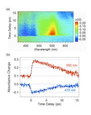
図1(a) 広帯域シングルショット分光により 計測したベータカロテンの吸収変化の時間・スペクトル2次元画像。(b)(a)の画像 から切り出した吸収変化の時間発展スペクトル。
