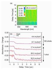
図 2 (a) シングルショットのポンプ光照射 (励起密度: 26.2 mJ/cm²) における結晶相 GST 薄膜の吸収変化の時間・波長 2 次元イメージ画像。(b) 異なる励起密度に対する吸収変化の時間発展スペクトル。点線は、指数関数的な立ち上がりを現象論的に仮定し、200 fs の半値幅を持つガウス型の装置関数を用いて畳み込み積分を行ったフィッティング結果を示す。
