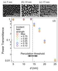
図 3 (a-c) 異なる膜厚の Au ナノ構造薄膜の SEM 画像。(d) 様々な膜厚の Au ナノ構造薄膜の THz 透過率の電場強度依存性
