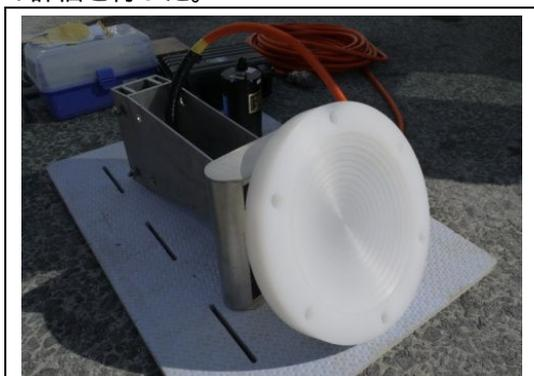
図3 距離1mの地点に位相距離を合わせて集束させるように設計したフレネルレンズ
