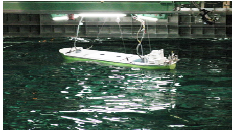
図 8 波風併存時の操船限界に関する水槽実験
