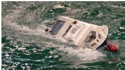
図4 多方向不規則発中を航走する漁船のブローチング現象再現実験
