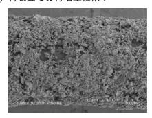
移植材料としては,直径 0.5mm,長さ 12mm のチタンロッドを用いた.表面処理としては,処理なしでチタンのままのもの,アパタイトコーティングのもの,そしてアパタイトコラーゲンをディッピング処理によりコーティングしたものの 3 種類を実験した.上図にアパタイトコーティングされたチタンロッドの SEM 写真を示す.これらの試料について動物実験を行った.
