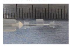
ポリメチルメタクリレートを材料として 血管吻合デバイスを試作した.外径 2.3mm, 内径 1.2mm であり,長さは外套が 2mm,キャップが 1.3mm である.
