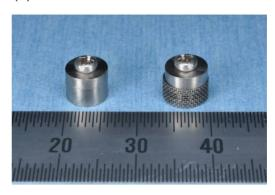
チタンを素材として上図に示すような試験片を作製した.図の左は対照群試料であり,側試料の側面は平滑となっている.一方,図の右に示すものは実験群試料であって,側面に周を一周する溝を掘り,更にその上をチタンのメッシュで覆ったものである.直径は6mm,高さは下部構造が3mmで上部構造が2mm,メッシュの開き目は0.2mmである.
