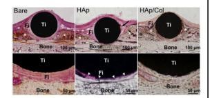
頭蓋骨表面における骨形成状況を上図に示す.黒い部分がチタン,図の下側が骨組織である.チタンロッドにより骨膜が持ち上間られた結果として生じる空間に周囲組造を出ったが再として組織が再生するありではよって異なる再生は組織で被覆されカプセルに対し、中央のアパタイトコーティングを組織でカプセル化された.これに対してもののでは対した。これに対してものアパタイトコラーゲンコーティンが観光とのアパタイトコラーゲンコーティンはのアパタイトコラーがとましては、材料は骨に直接的に接し周囲には顕著な骨の増生が観察された.
