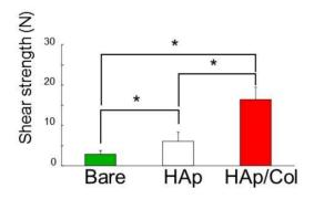
チタンロッドと頭蓋骨の接合強度を測定した結果を上図に示す.骨形成状況と対応してチタン,アパタイトコーティング,アパタイトコラーゲンコーティングの順に強度が増加していた.
