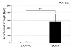
上図は接合強度の評価結果である.メッシュを設けた実験群(黒色)は平滑な対照群(白色)に比べて遥かに大きな結合力を示した. このようにコラーゲン線維がアンカリン グすることの出来る構造を設ければ,自己治癒反応により線維が形成され,更に皮膚内に作用する引張応力によりコラーゲン線維が配向して強固な結合を自発的に形成することが分かった.
