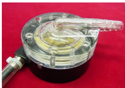
図2d: 試作した小児用補助人工心臓
