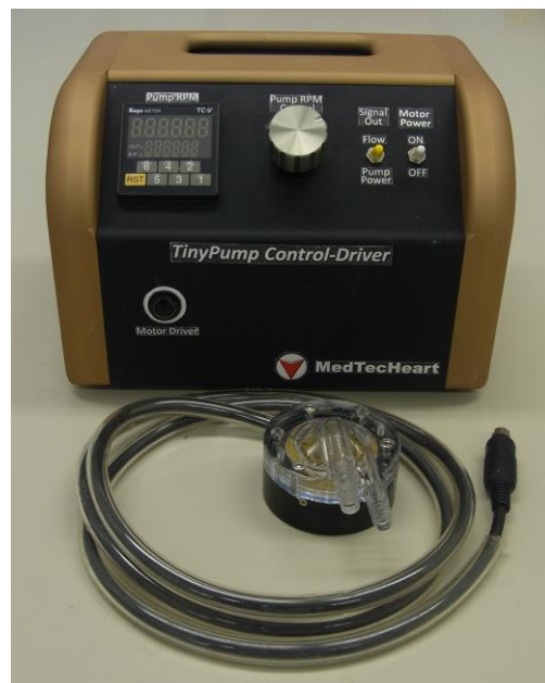
図2e: 試作した駆動用コンソールと小児用補助人工心臓
