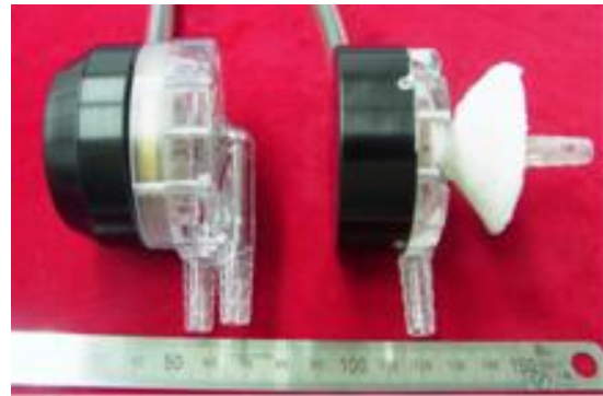
図 5 : 体外設置式小児用補助人工心臓 (左) と胸腔内植込み用補助人工心臓 (右)
