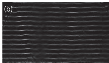
図6 小型水槽内部の定在波音場
