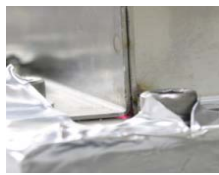
図4. 導波管のチャンバー導入部付近（熱で赤変）
