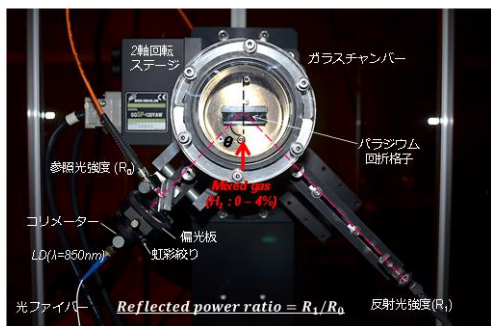
図8 パラジウム回折格子の水素含有雰囲気中でのプラズモン特性評価光学系
