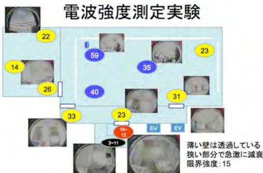
図9 電波強度測定実験
