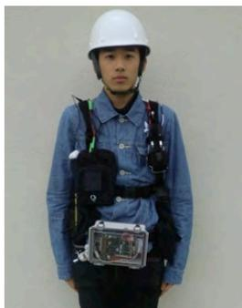
カ、ICT制御器を備え 図4ハーネス型試作機で駆動する。電源は6.6V、1.2AhのLiFe充電電池で駆動する。重量は電源を含み2.5kgある。
