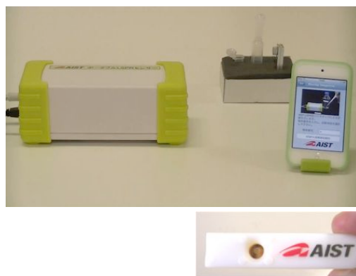
Figure 5 開発したポータブル超小型計測システム (上図中の左が計測器、上図中の右が制御機器：スマートフォンなどのデバイス、下図は計測器に挿入するチップ)
