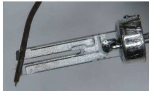
図1、マイクロ波源付水晶振動子型 AFM
