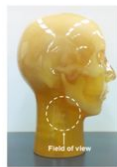
図2 実験に使用した人体頭部ファントム。X線照射位置を破線部で示す。
