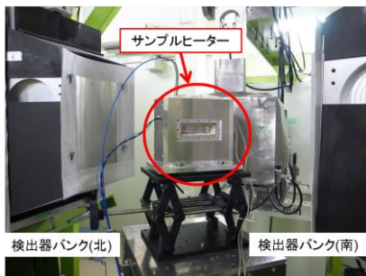
図 10 大強度パルス中性子による工学回折装置 TAKUMI における装置セットアップ。
