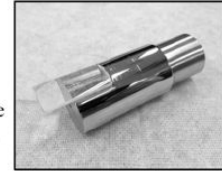
図 5 観察に使用した 2 種類の試験片，鏡面加工した SUS 304 ステンレス丸棒 とシリンドリカルレンズ
