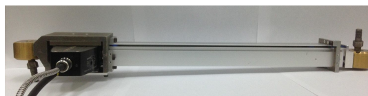
図 3 レーザ干渉計を内蔵した新形連結連鎖
