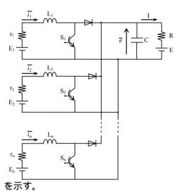
図 1. 昇圧チョッパを通して複数台の直流電 圧源が並列接続された回路
