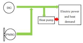
図 15. 風力発電機を単純に系統に接続した システム
