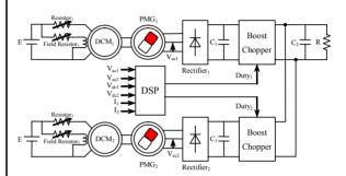
図 3. 小型風力発電実験システム
