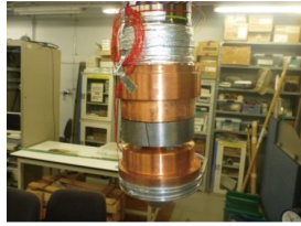
図 4 積層ケイ素鋼板の軸方向熱伝達特性測定径の外観写真
