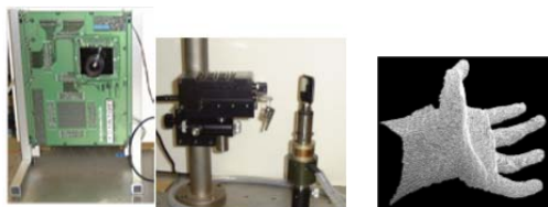
左から研究グループで構築した三次元形状測定用イメージセンサボード、ミラーを用いたレーザスキャナー、取得した三次元形状
