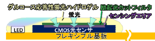
図2 グルコースセンサの基本構造
