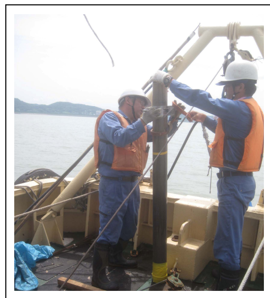
図 1 2011 年 8 月 2 日、野積海岸沖パイプロコアサンプリングによる柱状堆積物コアの船上への回収
