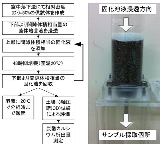
図-7 人工ビーチロック形成試験手順
