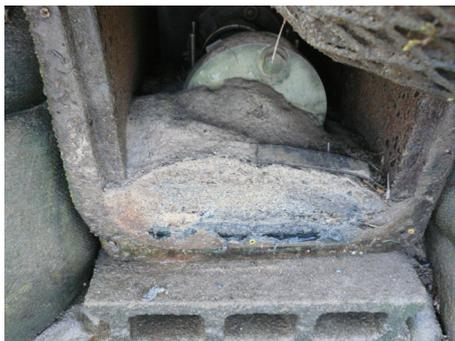
写真1 土砂に埋もれたトランスデューサー
