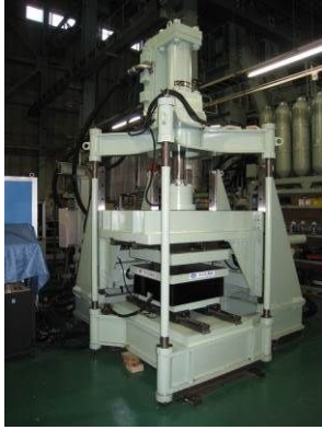
図3 水平2方向加力試験装置
