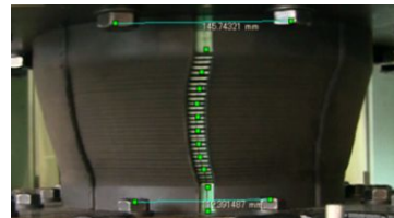
図8 鉛プラグ入り積層ゴム側面に観察されたねじれ変形
