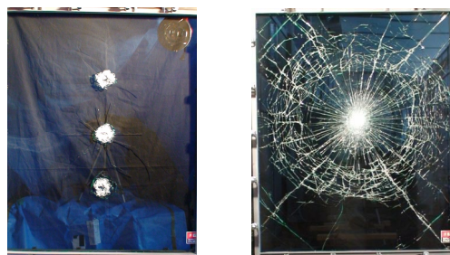
図 3 ISO 16932 に準じた合わせガラスに対する加撃試験結果の例
