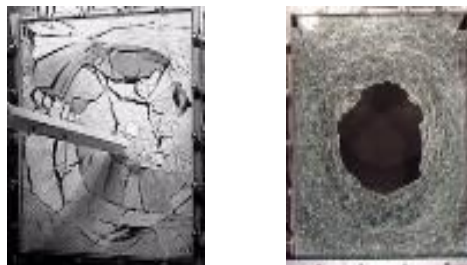
図 2 ISO 16932 に準じた合わせガラスに対する加撃試験結果の例
