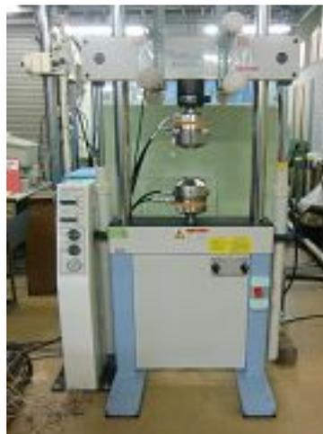
図1 50kN小型疲労試験機
