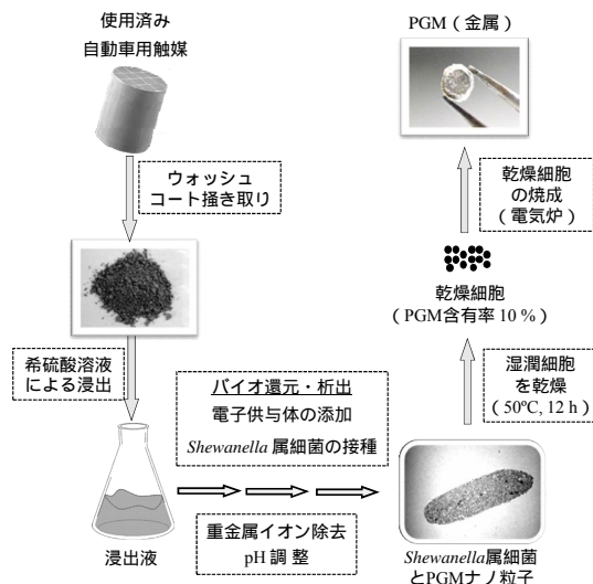
図 2 使用済み自動車触媒からの白金族金属 (PGM) のバイオ湿式回収フローシート
