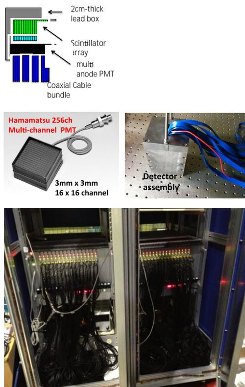
図2 上段多チャンネル散乱中性子計測器の構造図、中段に検出器部の写真、下段に多チャンネル信号記録用アナログデジタルコンバーター列の写真
