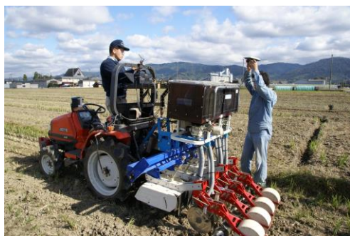
図1 播種深度を調節できる可変播種同時施肥機
