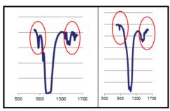
(左:セッコウを水熱処理した後にFT-IRで観察された炭酸基のピーク(丸印);右:スタチン含有セッコウを水熱処理した後にFT-IRで観察された炭酸基のピーク(丸印))
