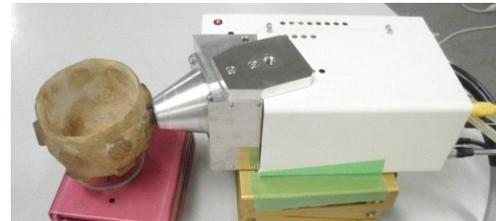
図1 新開発の微小部蛍光X線分析装置
