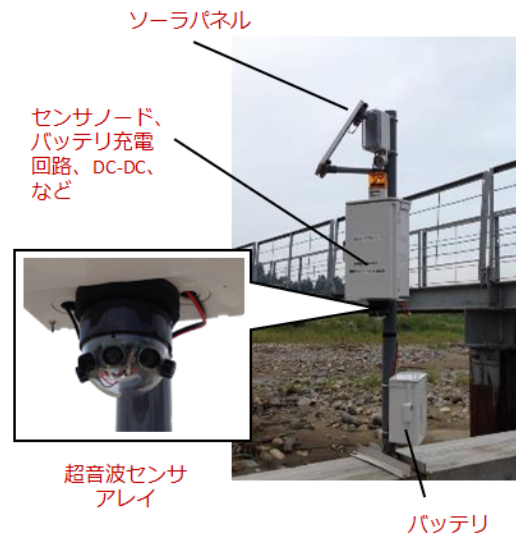
図8 ソーラパネルによるシステム
