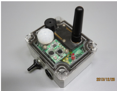
図2: プログラマブルセンサノード外観
