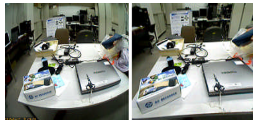
図2(a) 原画像 (b) 歪・ブレ補正結果
