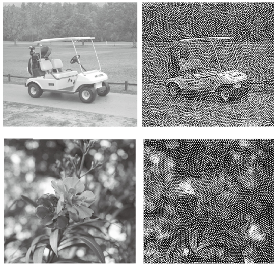
図 3 画像処理アルゴリズム評価用の実画像 ( http://marathon.csee.usf.edu/edge ) に対する提案アルゴリズムによる 2 値化結果。左：実画像 I(x, y) 、右：2 値化画像 H(x, y, t = 10) 。
