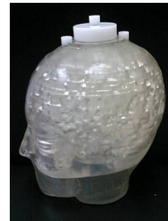
図5 脳を模倣したSPECT用ファントム。灰白質領域に放射性同位元素が封入されている。
