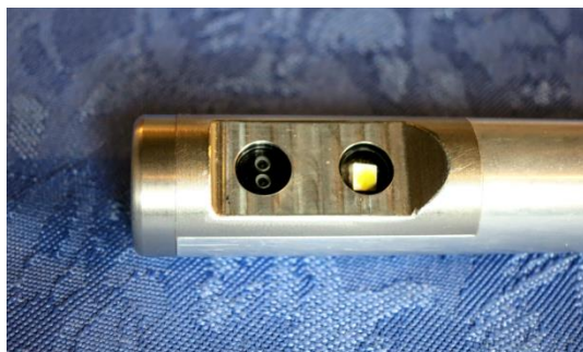
図4 ステレオ撮像装置の頭部（左側の穴にある二つの小円はレンズ、右側の穴にある白色矩形は試行錯誤により不要となった穴に付けたLED）
