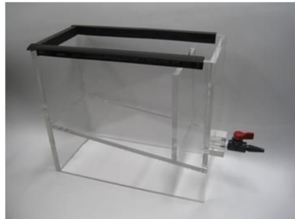
図1 足部体積計測用水槽
