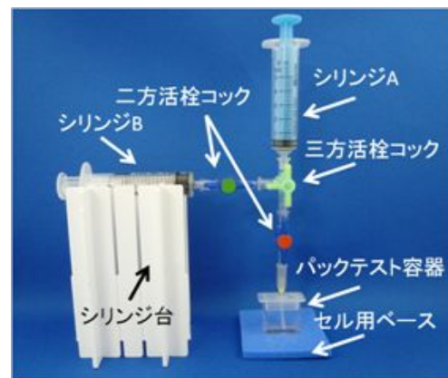
図3 二酸化窒素を用いた化学平衡実験
