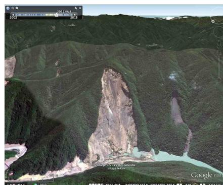
図7 平成 23 年 9 月に奈良県十津川村赤谷で発生した高さ 600mの大規模斜面崩壊と、それにより発生した土石流の3D画像(平成 27 年 7 月に Google Earth にて過去画像を選択して閲覧)
