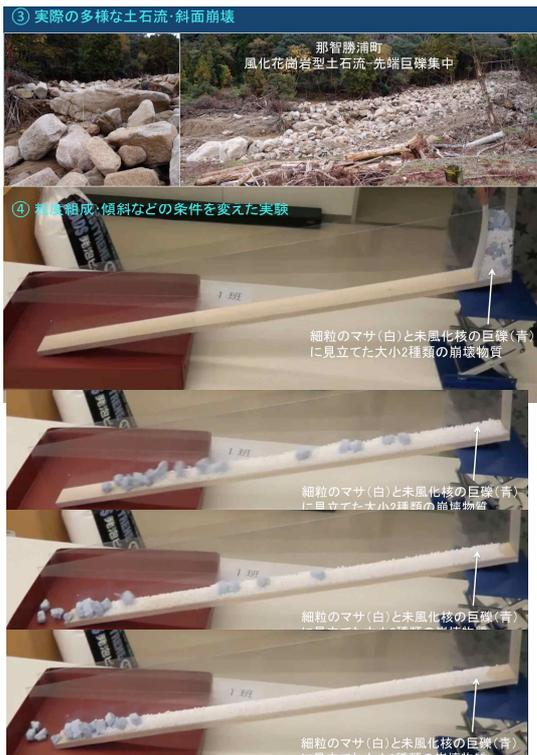
図8 平成23年9月に和歌山県那智勝浦町金山谷川で発生した熊野酸性岩類(花崗斑岩)地帯の土石流と、そのモデル実験
